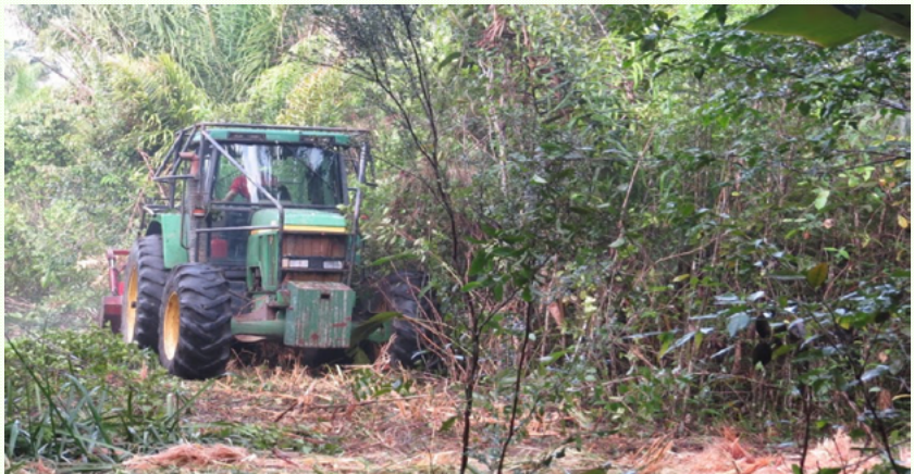
Fig. 2: Secondary forest shredder, AHWI Horizontal Tritucap, FM 600. Fonte: autora, 2017
